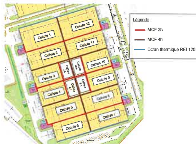
Répartition des murs coupe-feu du bâtiment LOG
